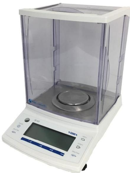
Рисунок 1 – Общий вид весов неавтоматического действия НТ
